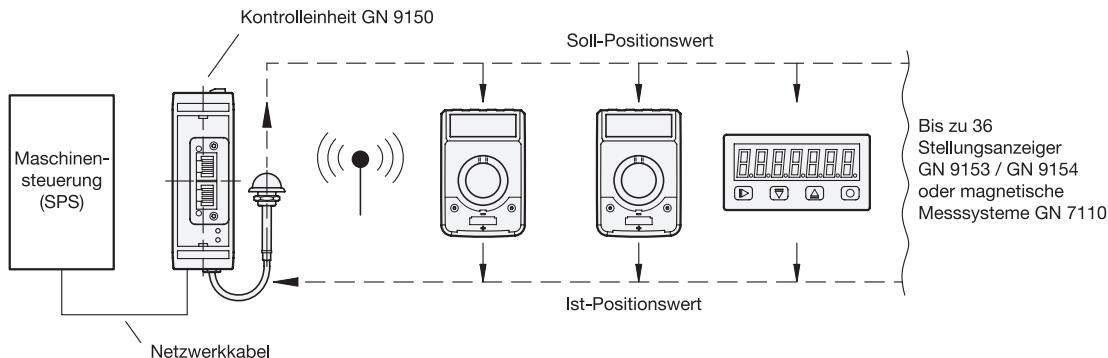
Stimmen Soll- und Ist-Positionswert nicht überein, fängt das LCD-Display des Stellungsanzeigers an zu blinken. Der Maschineneinrichter muss dann den Stellungsanzeiger auf den richtigen Wert einstellen. Das LCD-Display zeigt an, um welchen Wert der Ist-Positionswert vom Soll-Positionswert abweicht und in welche Richtung gedreht werden muss. Es muss solange gedreht werden, bis auf dem Display der Wert 0 erscheint, d. h. Nullabweichung zwischen Ist- und Soll-Positionswert.
