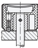
Drehknopf GN 624 / GN 624.5 mit Kugelraste zur Indexierung, befestigt mit Querstift.
