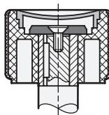
Drehknopf GN 624 / GN 624.5 befestigt mit Nabennut / Passfeder unter Verwendung von Vorlegescheibe GN 184 / GN 184.5 → Seite XYZ.
