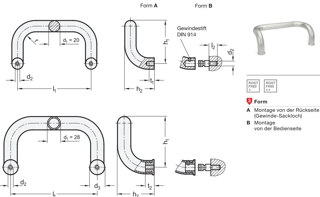
**3 Form****A** Montage von der Rückseite (Gewinde-Sackloch)**B** Montage von der Bedienseite
