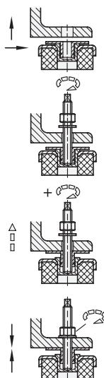
Maschine anheben, sodass der Maschinenfuß platziert werden kann.
