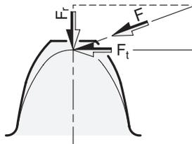
Die Tangentialkraft  $F_t$  wird dann über den Teilkreisdurchmesser mit dem Drehmoment korreliert. Folgende Formel gilt dann für das Nenn Drehmoment:
