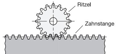
Der wichtigste, mechanische Wert für die Zahnstangen ist die maximale Kraft, die auf einen einzelnen Zahn ausgeübt werden kann. Die maximale Kraft ist in den Tabellen der jeweiligen Normblätter angegeben.
