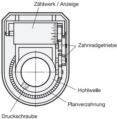
Die Übersetzung und Zählrichtung des Zählwerkes richtet sich nach der Steigung der Verstellspindel. Als Kenngröße dient der Anzeigewert nach einer Umdrehung ausgehend von der 0-Position. Nachkommastellen sind rot gekennzeichnet.
