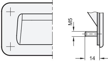
Senk-Dichtschrauben / Gehäuseichtung (bei Kennziffer 2)
