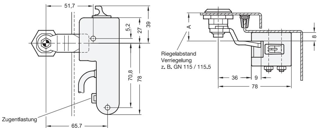
Nach erfolgter Montage kann das Anschlusskabel bei Bedarf zusätzlich durch einen Kabelbinder an der Zugentlastung befestigt werden. Das elektromechanische Verschlussystem GN 120.4 kann in bestehende Konstruktionen mit geringem Aufwand nachgerüstet werden. Der Aufbau des elektromechanischen Verschlussystems erfordert lediglich die Vergrößerung des Riegelabstands A der Verriegelung um 8 mm. Entsprechende Riegel sind für alle gängigen Riegelabstände lieferbar.
